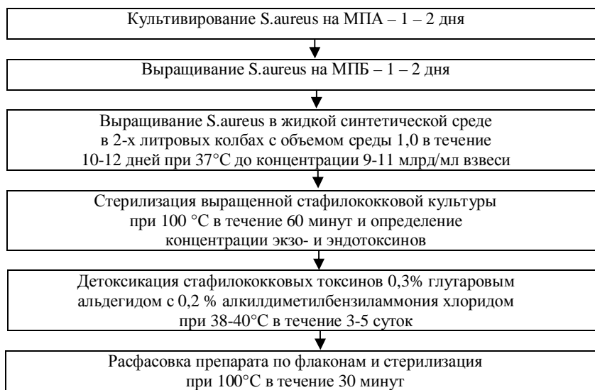
Рисунок 2 - Схема изготовления стафилококковой анатоксин-вакцины
