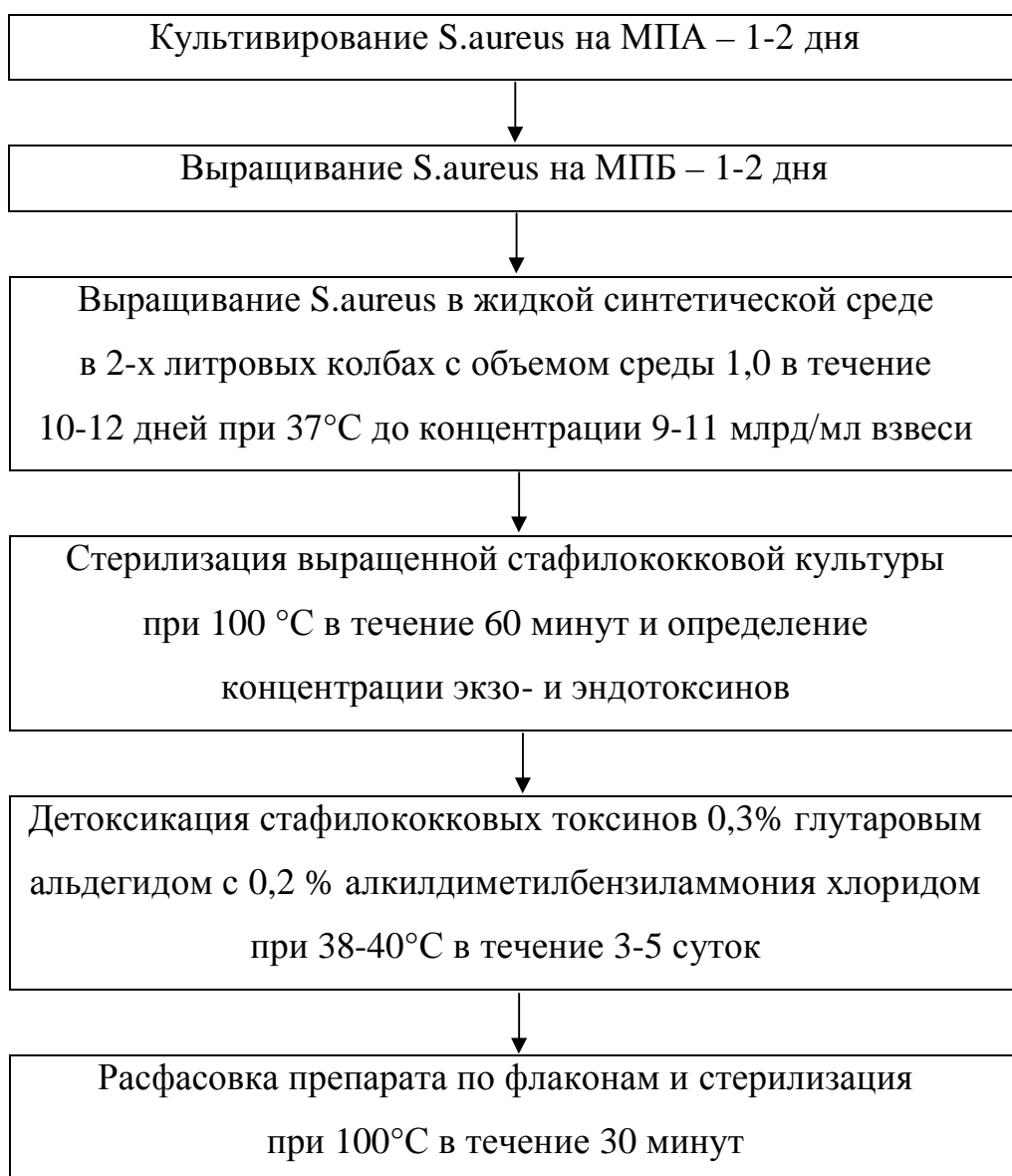
Рисунок 5 – Схема изготовления стафилококковой анатоксин-вакцины
