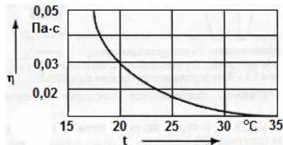
Рисунок 5.4 - Зависимость вязкости этиленгликоля от температуры
